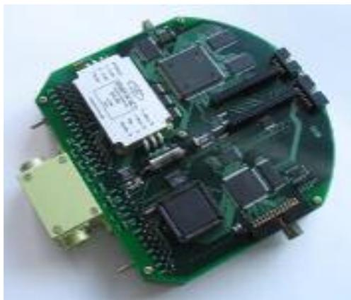
Рис. 9. Бортовой вычислитель «Сеанс» 2006 г.
